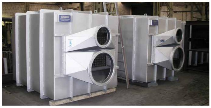
Rekuperatoren werden oft nach Ofenanlagen eingesetzt. Die für die Verbrennung benötigte Luft wird mit Hilfe der Abgase vorgewärmt. Die Energie wird effizient direkt im Prozess wiederverwendet.
